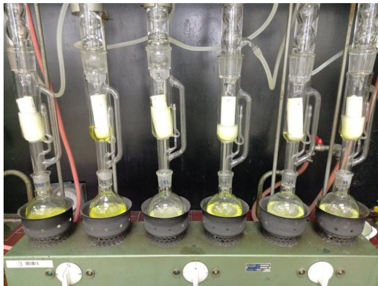
Slika 5. Ekstrakcija masti u aparaturi po Soxhletu (vlastiti izvor)
