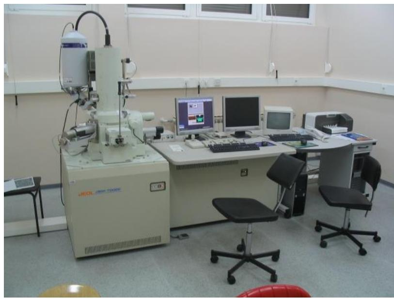
Slika 17. Visokorezolucijski pretražni elektronski mikroskop JSM- 7000F (Šestar, 2021)
