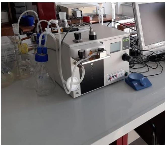
Slika 11. Büchi Encapsulator B- 390 (vlastita fotografija)
