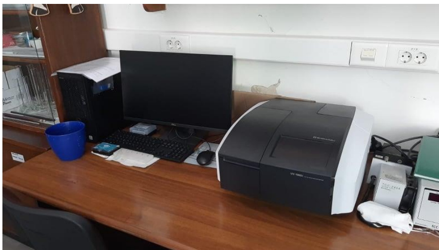
Slika 13. Shimadzu UV- 1900i spektrofotometar (vlastita fotografija)
