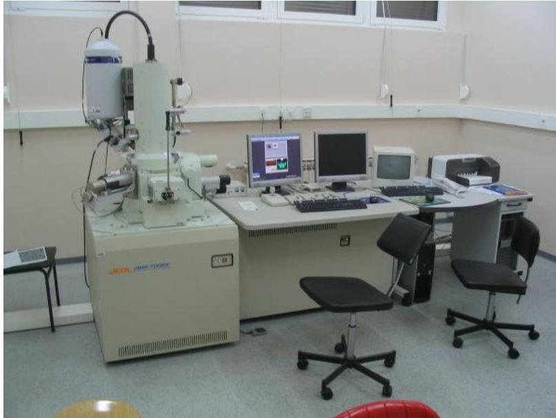
Slika 17. Visokorezolucijski pretražni elektronski mikroskop JSM- 7000F (Šestar, 2021)
