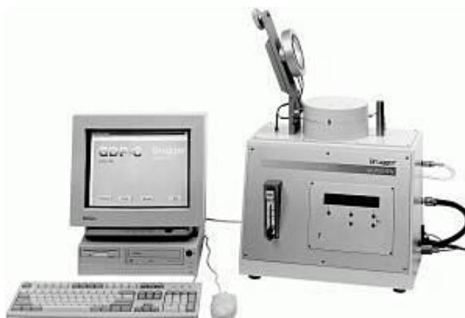
Slika 9. Instrument za mjerenje propusnosti plinova (Anonymus 7, GDP-C Brugger, Njemačka)
