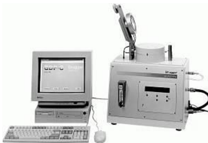
Slika 9. Instrument za mjerenje propusnosti plinova (Anonymus 7, GDP-C Brugger, Njemačka)
