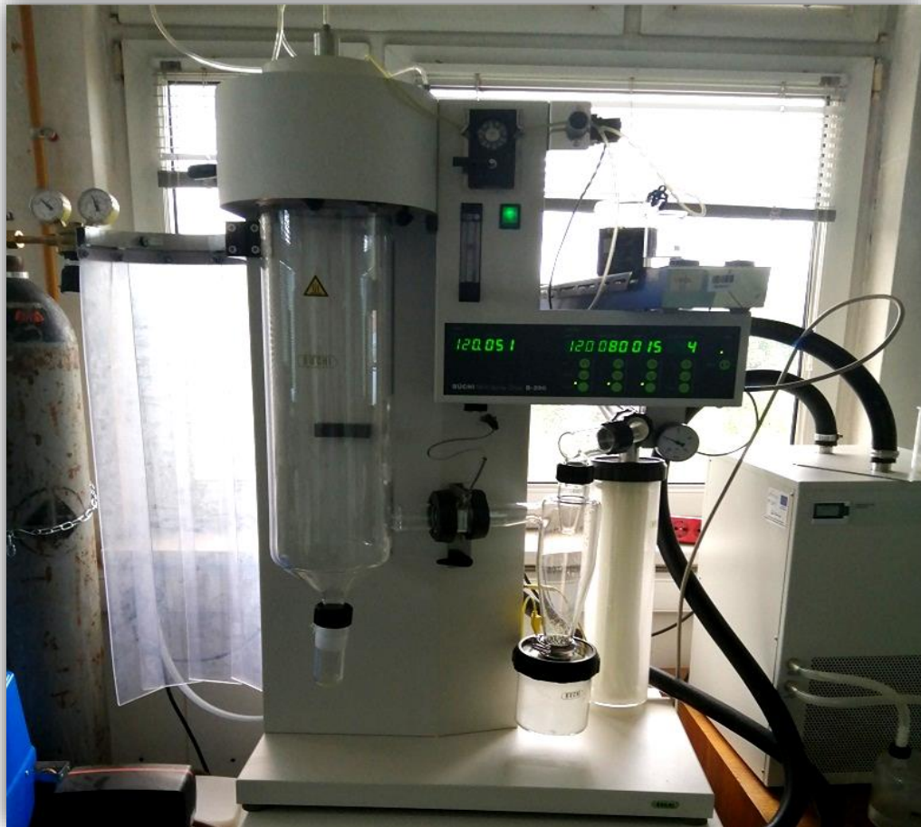
Slika 4. Uređaj za sušenje raspršivanjem Buchi Mini Spray Dryer B – 290, Švicarska (vlastita fotografija)
