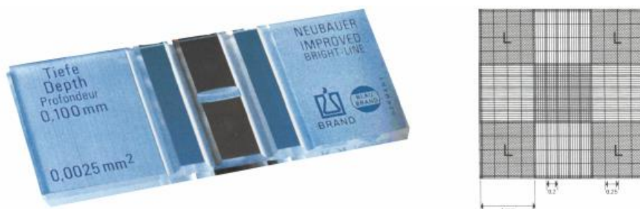
Slika 5. Prikaz Neuebaureove komorice za brojanje stanica. (Anonymus 2, 2021)
