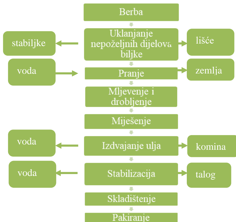
Slika 5. Opća tehnološka shema proizvodnje maslinovog ulja
