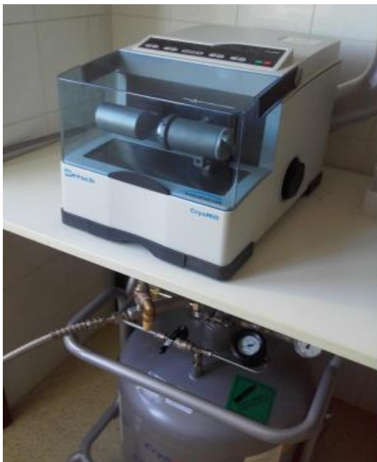
Slika 2. Vibracioni kriomlin i spremnik za tekući dušik (proizvođač Retsch i Apollo) (Anonymus 2)
