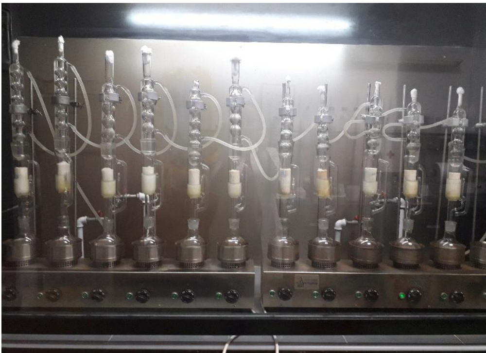
Slika 4. Aparatura po Soxhletu (vlastita fotografija)
