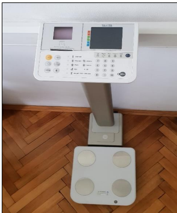
Slika 8. Analizator sastava tijela TANITA Inner Scan DC-430U – dual frequency Total body composition analyzer (Festta d.o.o.) (vlastita fotografija)
