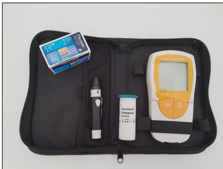
Slika 7. Uređaj za mjerenje glukoze i kolesterola iz kapilarne krvi Accutrend® Plus System ( Roche Diagnostic USA ) (vlastita fotografija)
