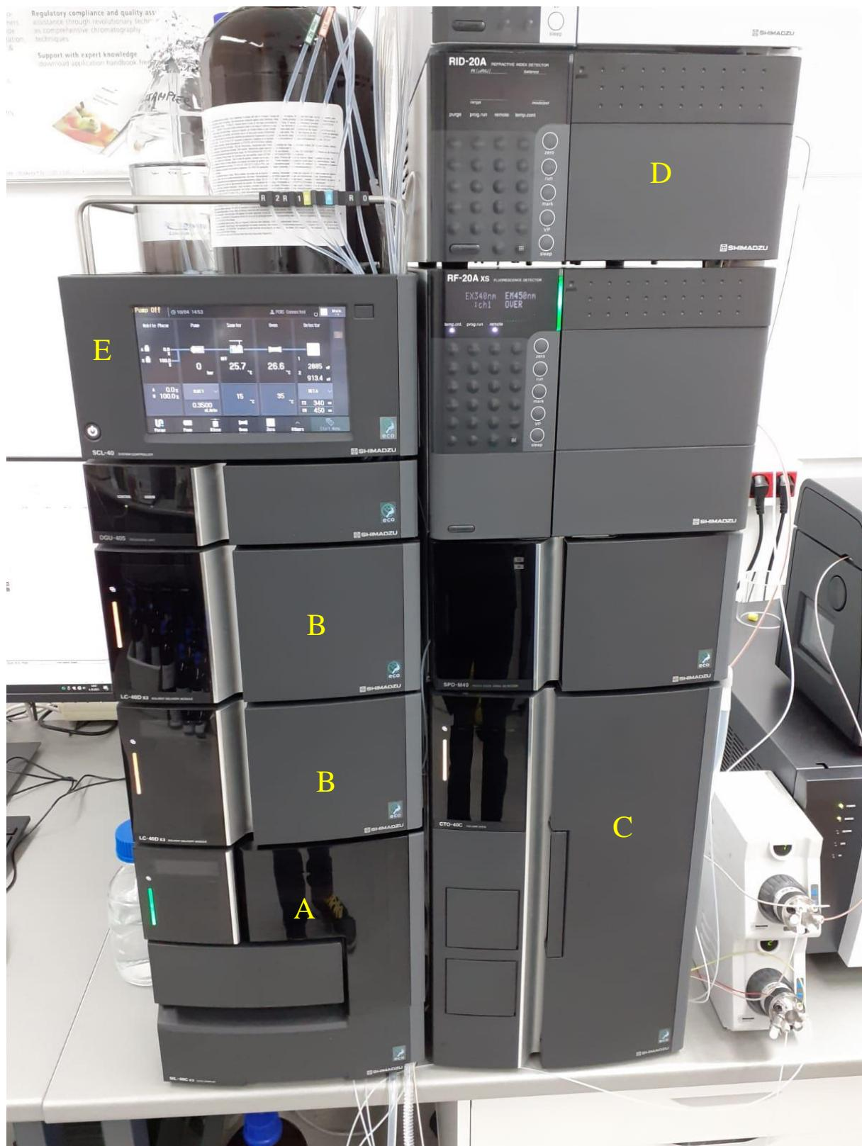
**Slika 11.** HPLC uređaj i njegovi sastavni dijelovi: A – automatski uzorkivač, B – jedinice za otopala / pumpe, C – pećnica za kolonu, D – detektor indeksa loma, E – upravljačka jedinica
