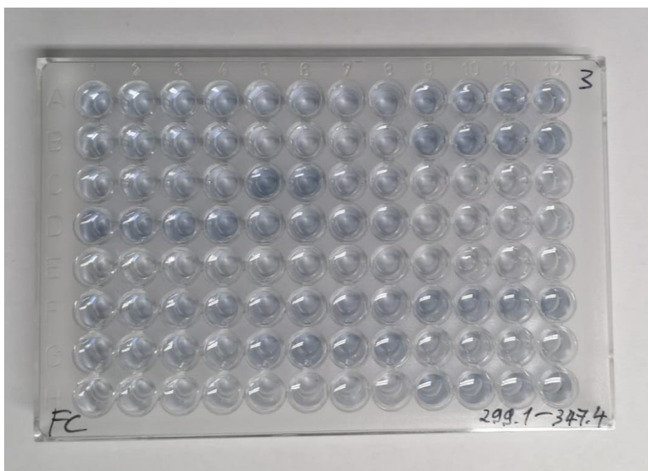
Slika 8. Mikrotitarska pločica s uzorcima i reagensima za određivanje ukupnih fenola (vlastita fotografija)
