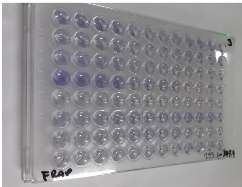
Slika 10. Mikrotitarska pločica s uzorcima i reagensima za FRAP metodu ( vlastita fotografija )
