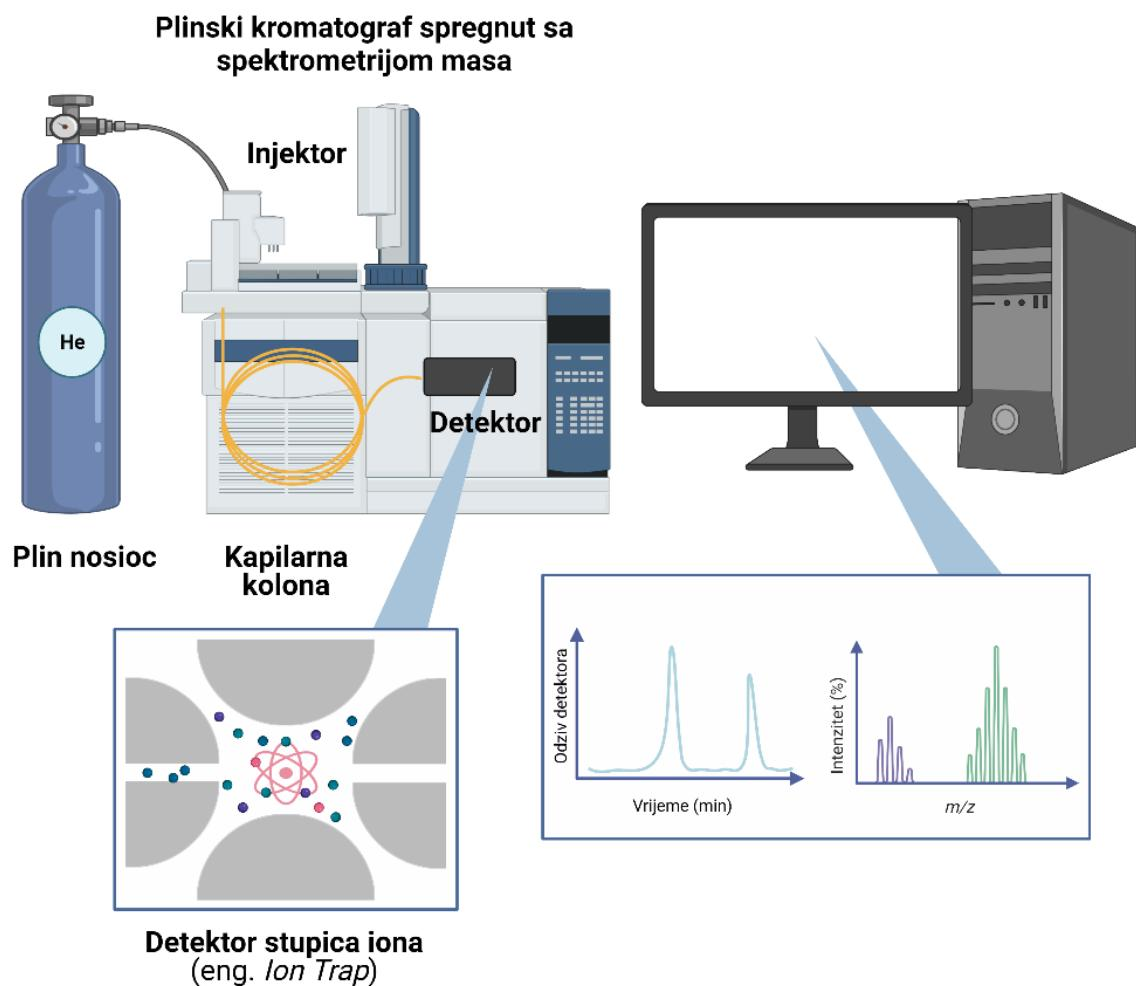
**Slika 14.** Shematski prikaz plinskog kromatografa sa spektrometrom masa.
