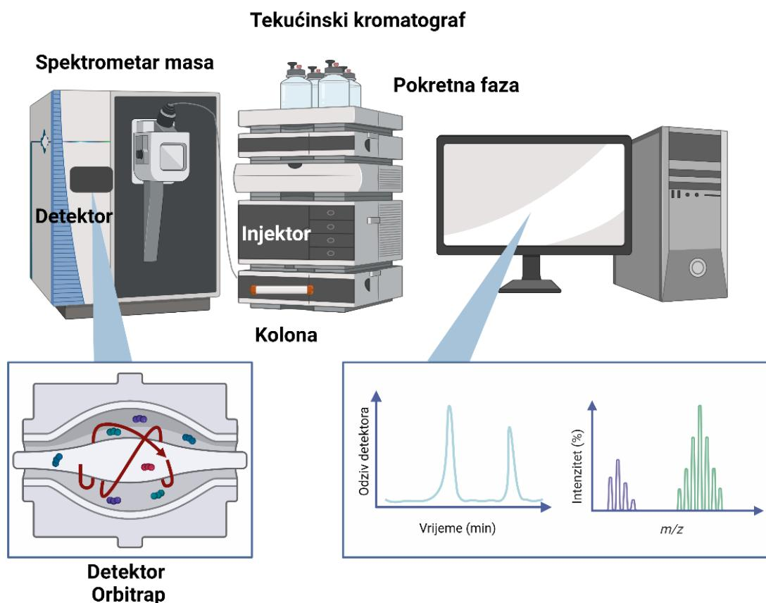
**Slika 13.** Shematski prikaz tekućinskog kromatografa sa spektrometrom masa
