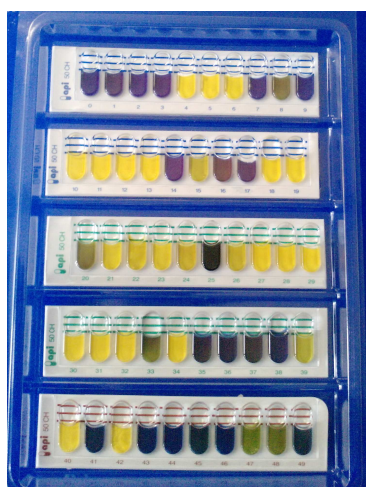
Slika 5. Prikaz fermentacijskih profila šećera bakterije mliječne kiseline određen API 50 CHL testom
