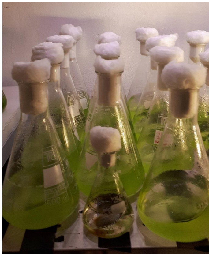
Slika 5. Aerobni uzgoj mikroalge Picochlorum sp. na tresilici (vlastita fotografija)
