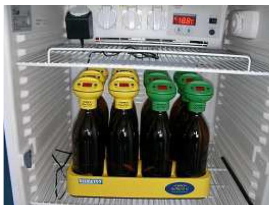
Slika 9. Set od 12 OxiTop boca s pripadajućim senzorima, elektromagnetskom miješalicom i termostatom radi osiguravanja konstantne temperature tijekom određivanja (Perić, 2012)
