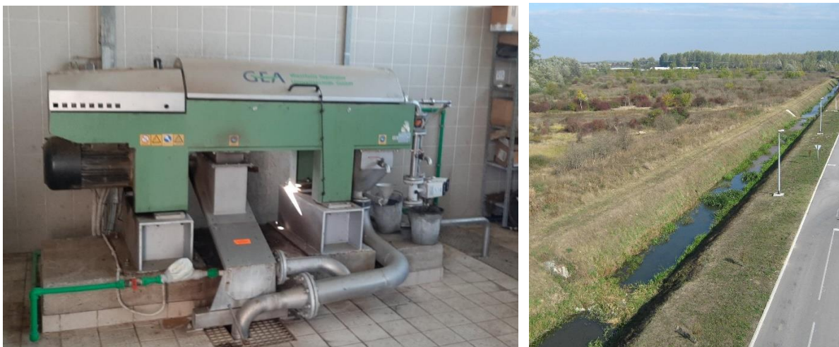
Slika 8. a) Centrifugalni dekanter, b) recipijent (Anonymous, 2021)
