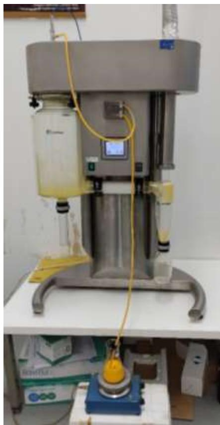
**Slika 7.** Uredaj za sušenje raspršivanjem (vlastita fotografija)
