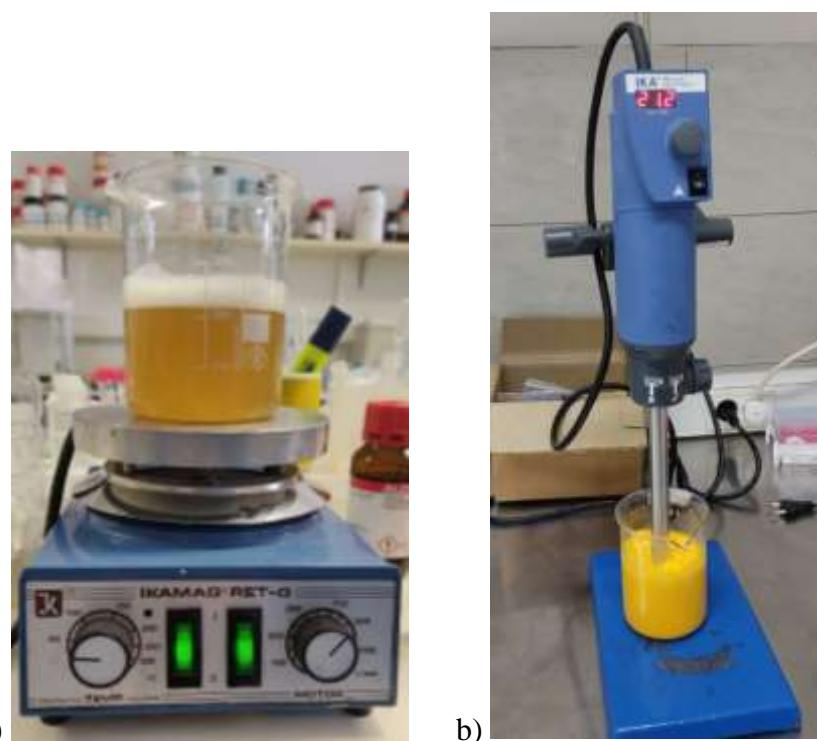
**Slika 6.** a) Otopljena arapska guma u destiliranoj vodi nakon 24 h na magnetskoj miješalici (vlastita fotografija); b) Uzorak ulja se homogenizira zajedno s već pripremljenom smjesom na uređaju Ultra turrax prije procesa sušenja raspršivanjem (vlastita fotografija)
