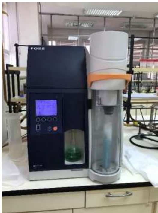
Slika 7. Određivanje udjela proteina Kjeldahlovim postupkom, postupak destilacije u Floss Kjeltec 8100 (vlastita fotografija)
