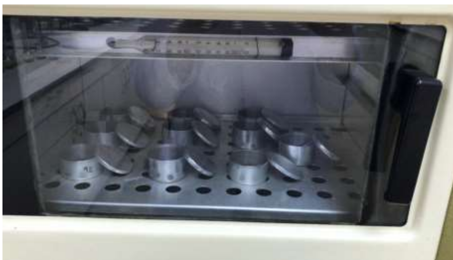
Slika 6. Sušenje uzorka u zračnoj sušnici (vlastita fotografija)
