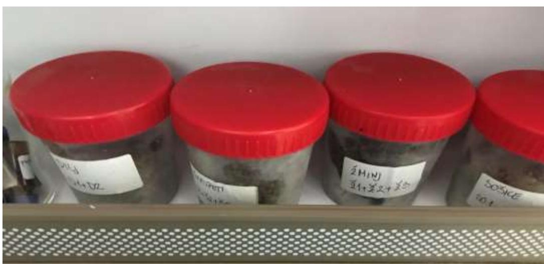
Slika 5. Homogenizirani uzorci u sterilnim plastičnim čašicama u hladnjaku (vlastita fotografija)
