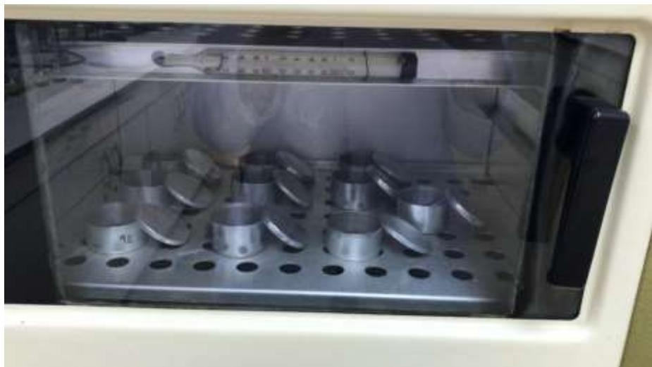
Slika 6. Sušenje uzorka u zračnoj sušnici (vlastita fotografija)
