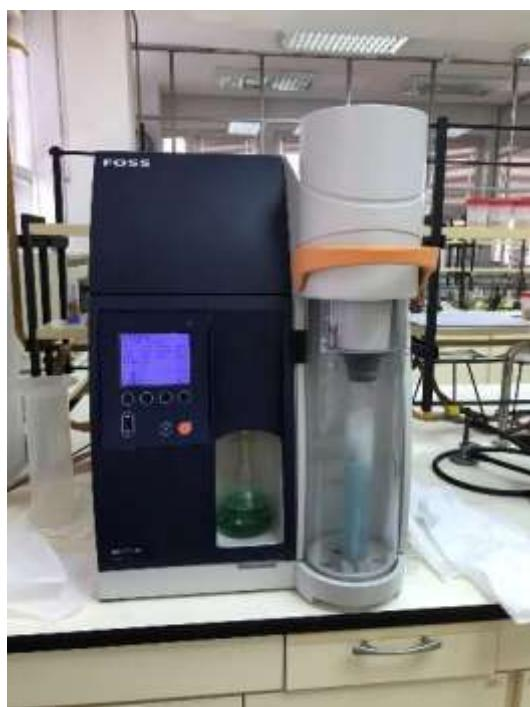
Slika 7. Određivanje udjela proteina Kjeldahlovim postupkom, postupak destilacije u Foss Kjeltec 8100 (vlastita fotografija)
