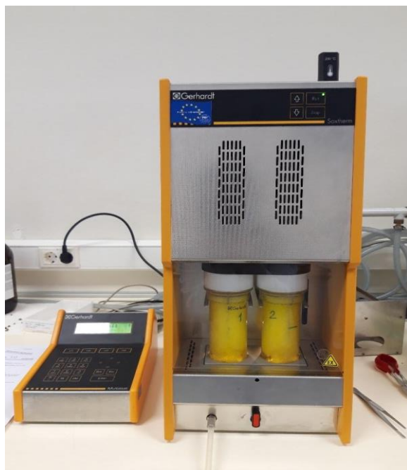
Slika 13. Soxhlet ekstraktor (vlastita fotografija)
