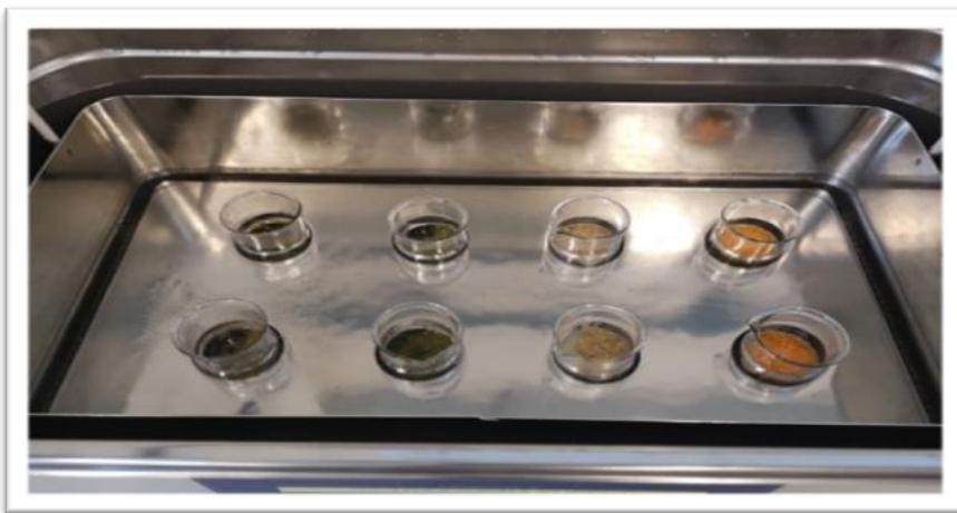
**Slika 2.** Uzorci u ultrazvučnoj kupelji (Elmasonic, P300H, Elma, Njemačka) (*vlastita fotografija*)
