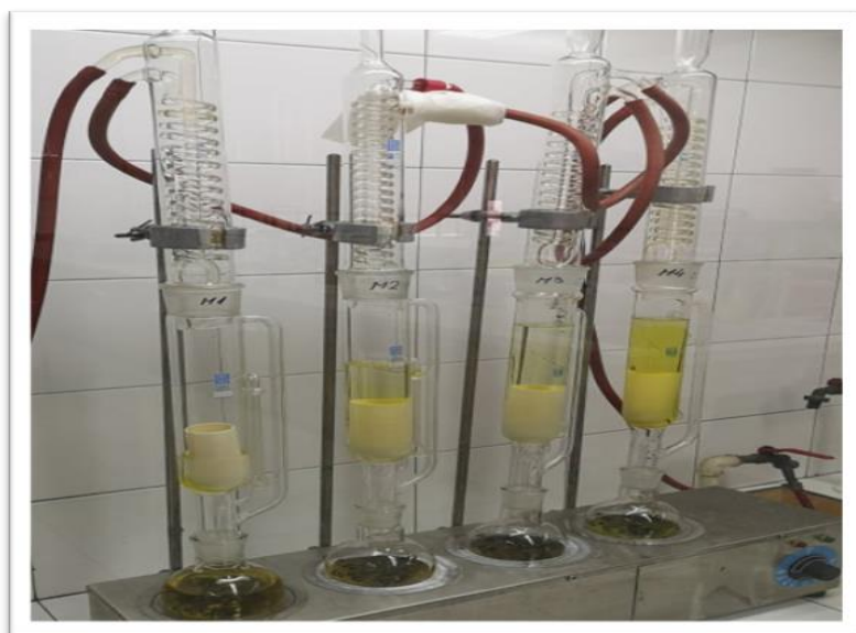
Slika 1. Soxhlet ekstrakcija ( vlastita fotografija )
