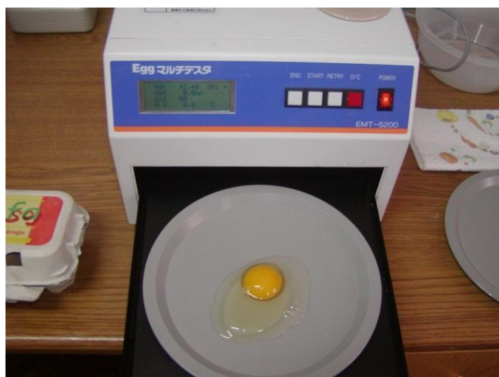
Slika 4. Egg Multi-Tester EMT 5200 za određivanje HJ i boje žumanjka (Leko, 2016)
