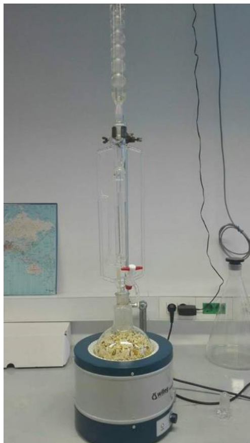
Slika 1. Aparatura po Clevenger-u (Tutek, 2017)
