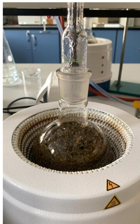
**Slika 11.** Okrugla tirkvica sa suspenzijom u aparaturi po Clevenger-u (vlastita fotografija)
