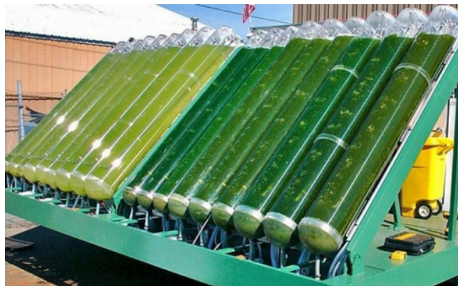
Slika 1. Fotobioreaktorski sustavi za uzgoj mikroalgi [18]
