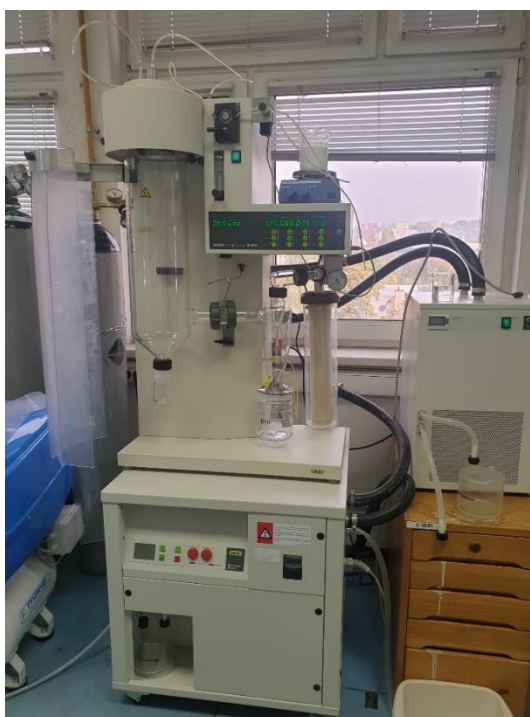
Slika 6. Mini Spray Dryer B-290 (vlastita fotografija)
