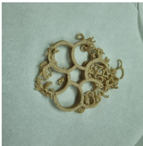
Slika 4. Uzorak tiskan pri temperaturi 80 °C, 80A
