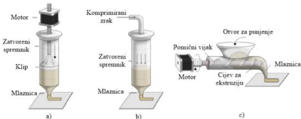
Slika 1. Mehanički mehanizmi ekstruzije u 3D tiskanju hrane (Sun i sur., 2018)
