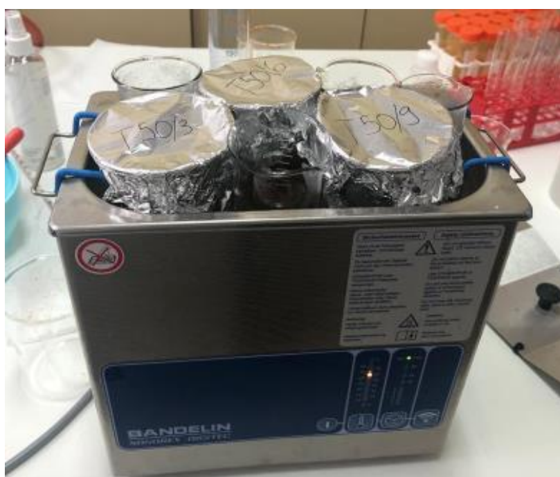
Slika 6. Tretiranje uzoraka s 50 % etanola u vodenoj kupelji (vlastita fotografija)
