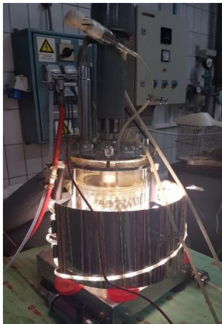
Slika 13. Fotobioreaktor za uzgoj mikroalgi (vlastita fotografija)
