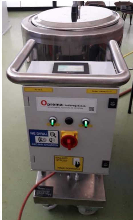
Slika 13. Šaržni pasterizator PS-100 (Oprema Ludbreg d.o.o. Hrvatska)
