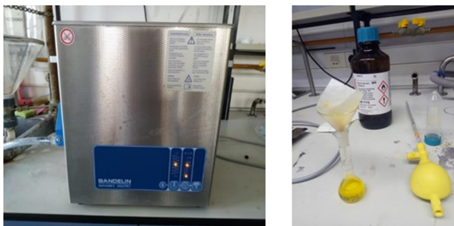
Slika 17. Ultrazvučna kupelj Bandelin Sonorex (Njemačka) (lijevo) i filtracija ekstrakata smoothie napitaka (desno)
