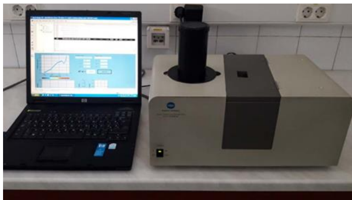
Slika 15. Spektrofotometar CM-3500d, Konica-Minolta (Japan)
