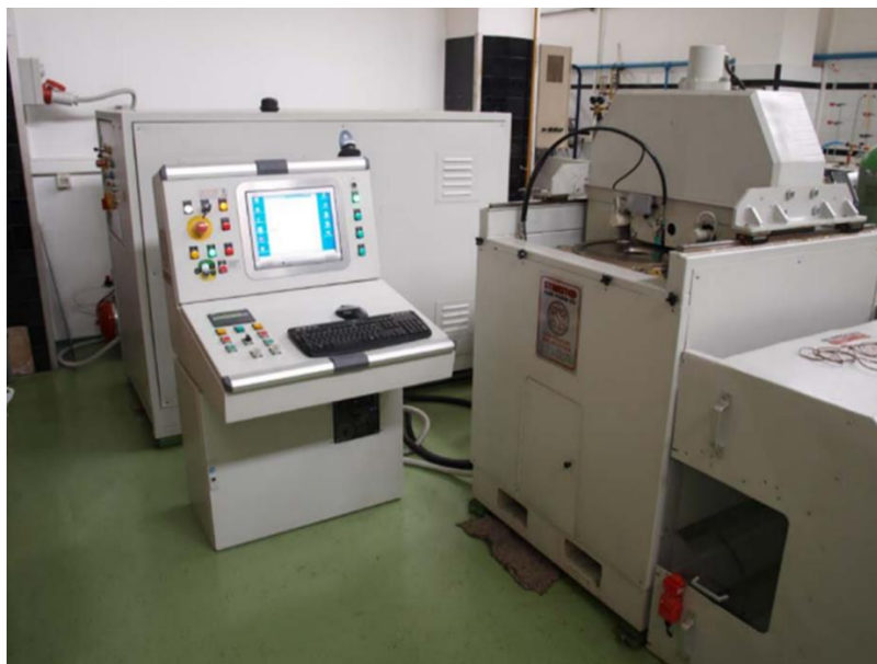
Slika 12. Uređaj za obradu visokim hidrostatskim tlakom Stansted Fluid Power (Velika Britanija)
