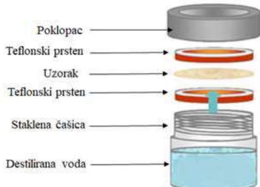
Slika 1. Čašica i sastavni elementi zatvarača za mjerjenje propusnosti vodene pare
