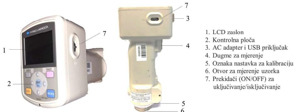
Slika 2. Shema kolorimetra Konica Minolta (vlastita fotografija)
