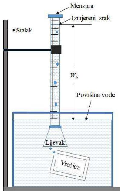
Slika 1. Aparatura za mjerjenje ostatnog zraka
