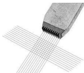
Slika 1. Primjer češlja za ucrtavanje više paralelnih linija na površinu lakiranog uzorka
