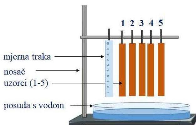
Slika 1. Aparatura za određivanje kapilarnog upijanja vode
