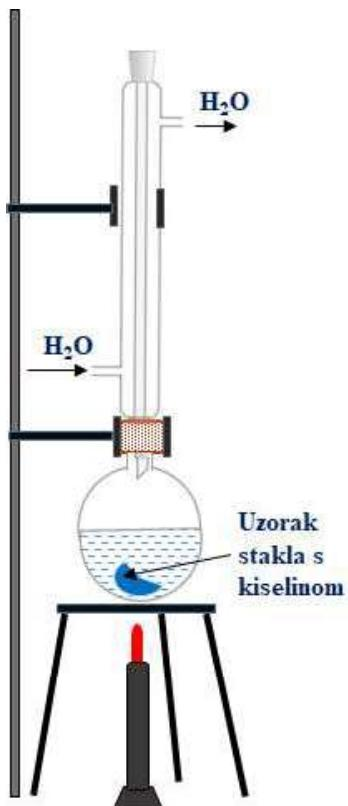
Slika 1. Aparatura za određivanje otpornosti stakla na kiseline
