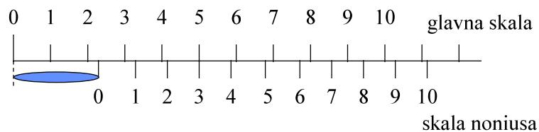
**Slika 2a. Primjeri (a, b, c) položaja skale za očitanja debljine materijala**
