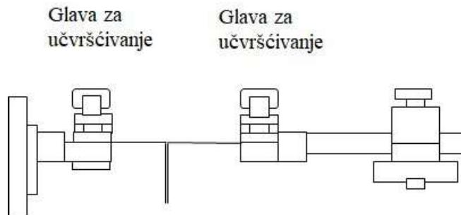
Slika 2. Položaj uzorka za određivanje čvrstoće šava
