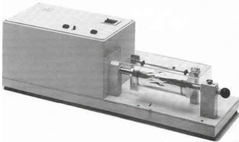
**Slika 1. KFT Uredaj za simulaciju savojne otpornosti fleksibilnih ambalažnih materijala (Brugger prospect)**
