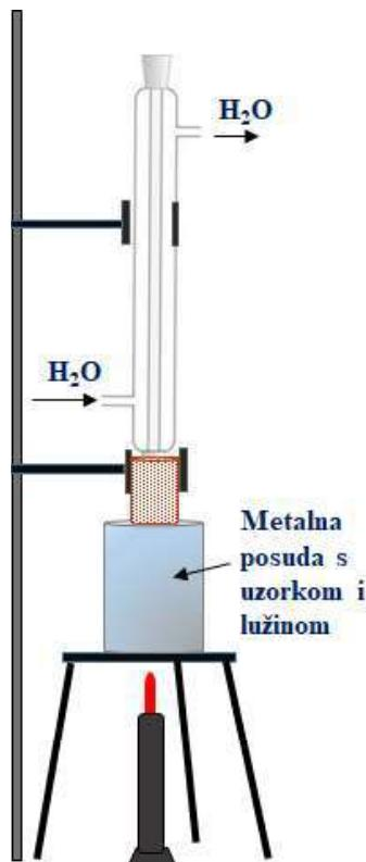
Slika 1. Aparatura za određivanje otpornosti stakla na lužine
