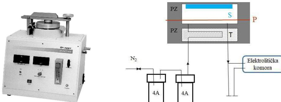
**Slika 1. Uredaj (WDDG, Brugger) i shema aparature za određivanje propusnosti ambalažnog materijala na vodenu paru (Brugger, 1987)**
