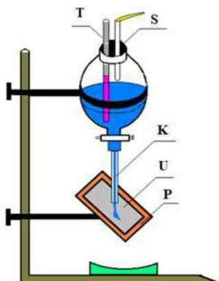
Slika 1. Shema aparature za određivanje debljine galvanske prevlake metodom mlaza
