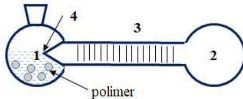
**Slika 2. Uredaj za volumetrijsko određivanje stupnja bubrenja**
