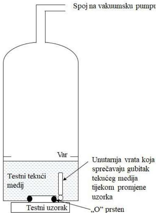
Slika 1. Tehnika vakuumskog komora
