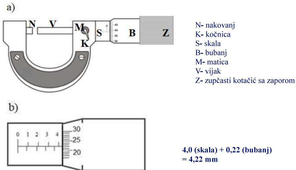
Slika 1. Dijelovi mikrometarskog vijka (a) i primjer očitanja debljine materijala (b)
