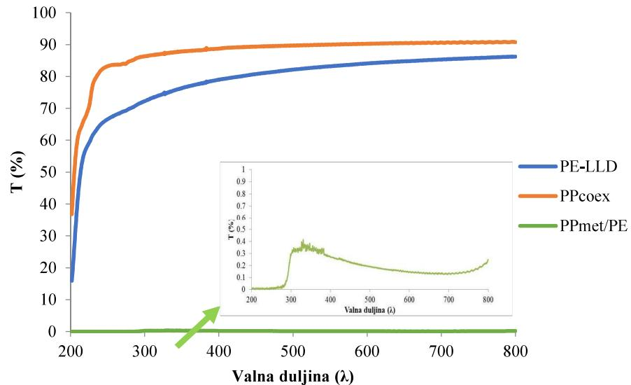
Slika 2. Primjer snimljenog spektra (% transmisije, T) kod različitih uzoraka polimernih filmova (vlastito mjerjenje)
