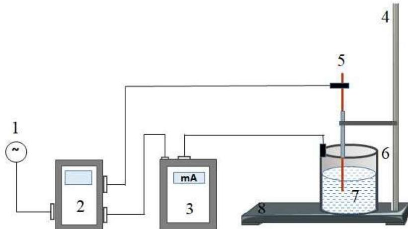
**Slika 1. Aparatura za mjerjenje poroznosti laka prema Ettingeru**
