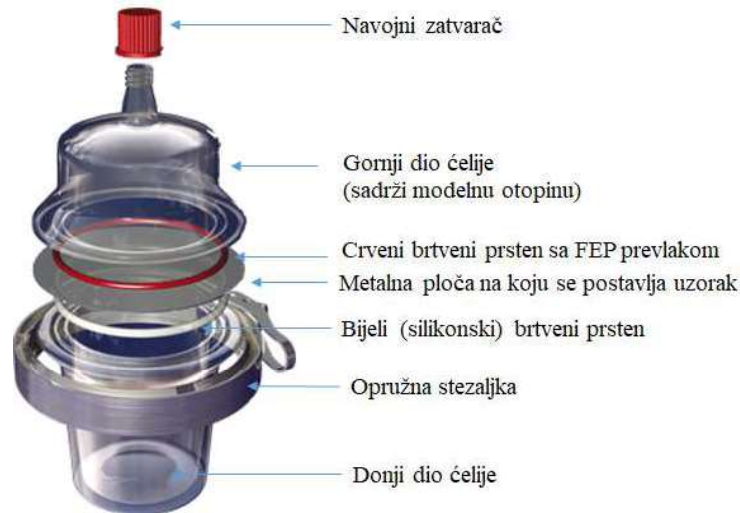
Slika 1. Ćelija (Migracell®) za određivanje ukupne migracije (MigraCell prospect) FEP = fluorinirani etilen propilen
