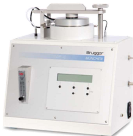
Slika 4. GDP-C aparat za određivanje propusnosti ambalažnog materijala na plinove (Brugger Manual, 2008)
