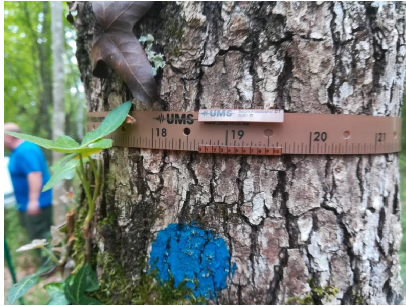
Slika 12. Određivanje prirasta pomoću dendrometerskih traka na plohi hrasta medunca
