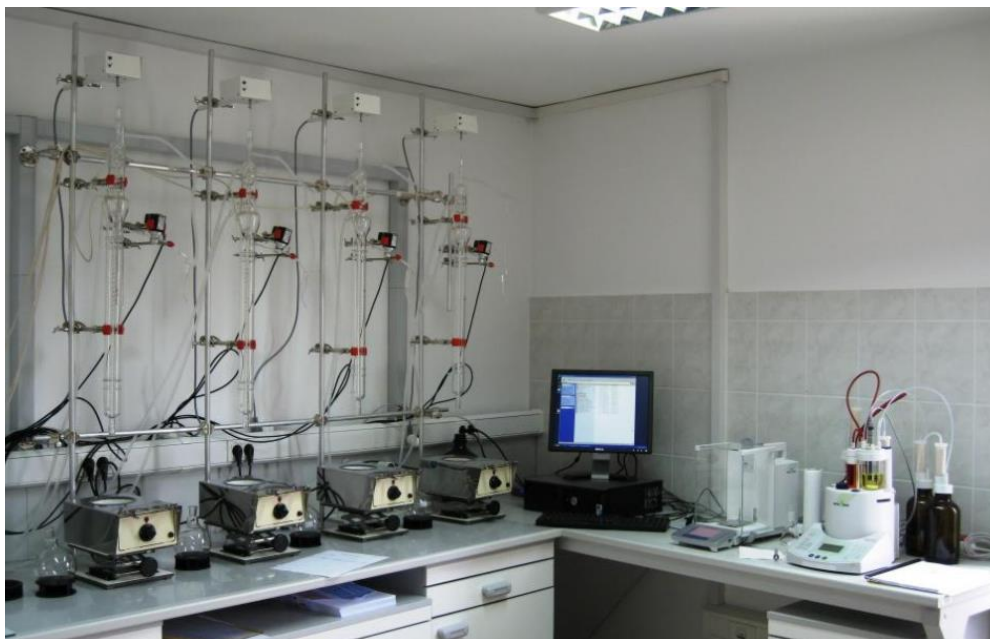
Slika 3. Automatizirani sustav za destilaciju (lijevo) i automatski volumetrijski titrator po Karl Fischeru (desno) u laboratoriju HAPIH-CVVU. Vlastita fotografija.
