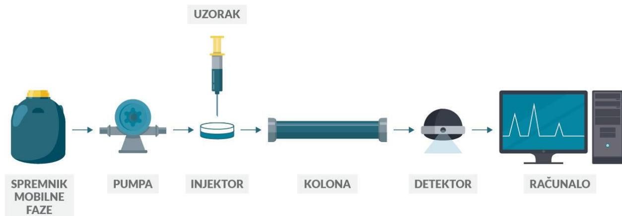
**Slika 13.** Shematski prikaz sustava za tekućinsku kromatografiju
