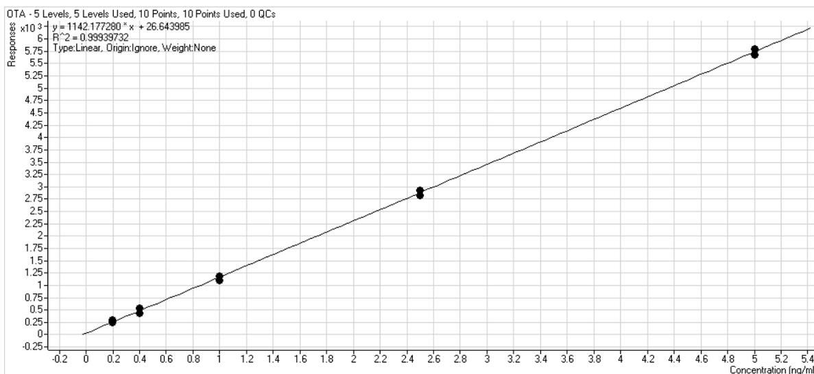
**Slika 49.** Standardna kalibracijska krivulja OTA – linearnost u koncentracijskom rasponu od 0,20 - 5,00 ng/mL
