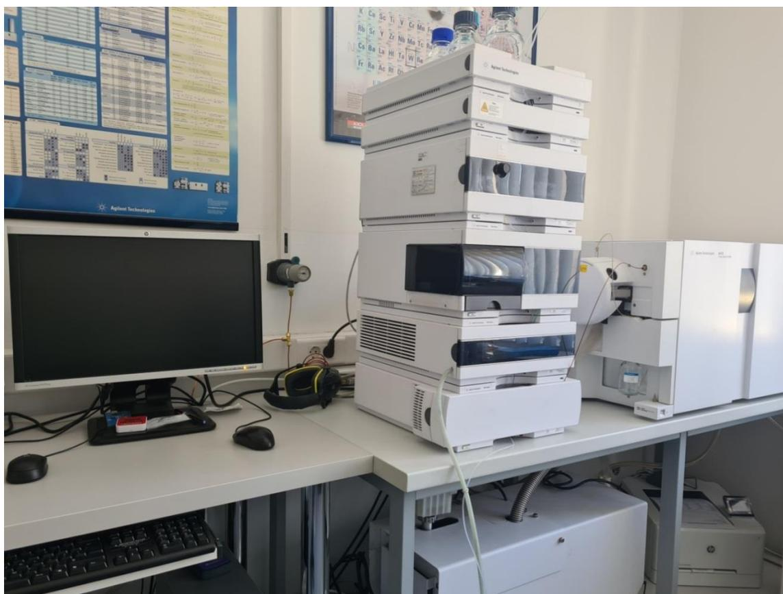
**Slika 19.** Tekućinski kromatograf sa tandemskom spektrometrijom masa (LC-MS/MS) Agilent Technologies (vlastita fotografija)
