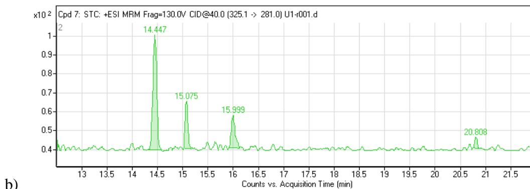
**Slika 45.** LC-MS/MS-MRM (engl. *Multiple Reaction Monitoring*) kromatogrami *blank* uzorka obogaćenog STC na razini od 0,1 µg/kg a) 325,1 →310,0; b) 325,1 →281,0
