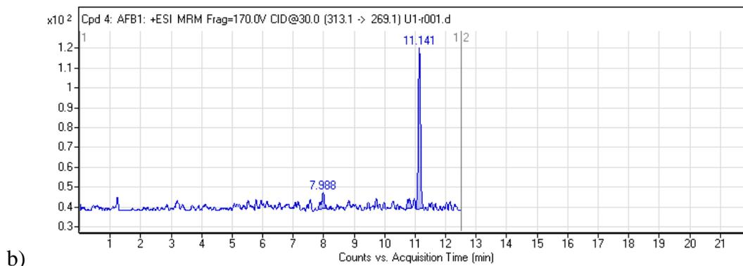
**Slika 44.** LC-MS/MS-MRM (engl. *Multiple Reaction Monitoring*) kromatogrami *blank* uzorka obogaćenog AFB<sub>1</sub> na razini od 0,1 µg/kg a) 313,1,0 →285,1; b) 313,1 →269,1
