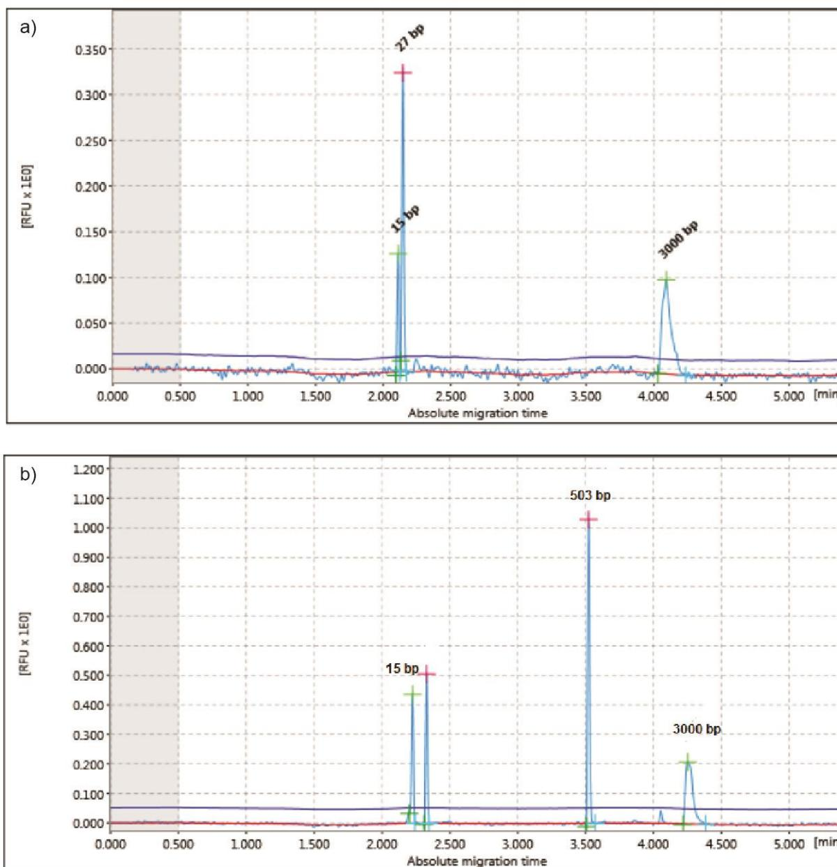
**Slika 40.** Primjer elektroferograma dobivenog kapilarnom elektroforezom PCR produkata dobivenih umnožavanjem DNA (*otapks*) s početnicama AoLC35-12R i AoLC35-12F veličine 520 pb iz identificiranih izolata potencijalnih producenata OTA s površine uzoraka TMP a) negativnog uzorka b) pozitivnog uzorka
