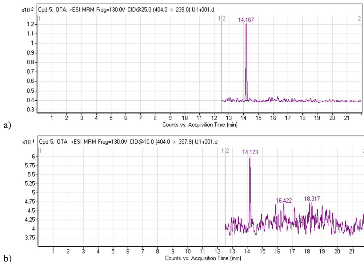
**Slika 43.** LC-MS/MS-MRM (engl. *Multiple Reaction Monitoring*) kromatogrami *blank* uzorka obogaćenog OTA na razini od 0,3 µg/kg a) 404,0 →239,0; b) 404,0 →357,9
