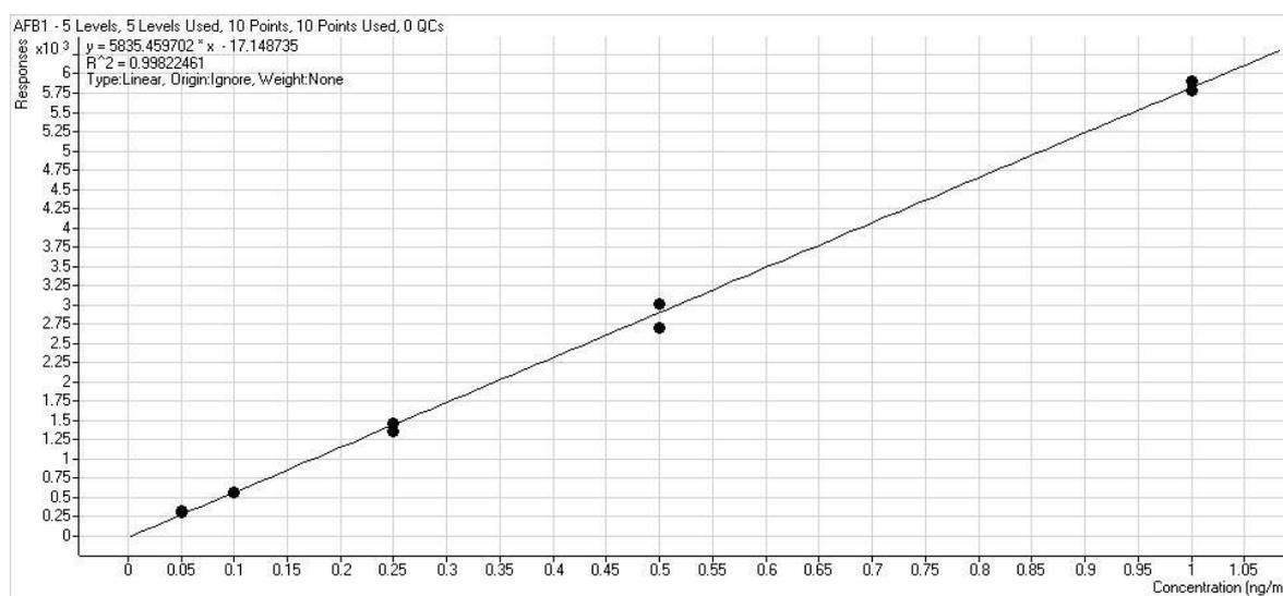
**Slika 48.** Standardna kalibracijska krivulja AFB<sub>1</sub> - linearnost u koncentracijskom rasponu od 0,05 - 1,00 ng/mL
