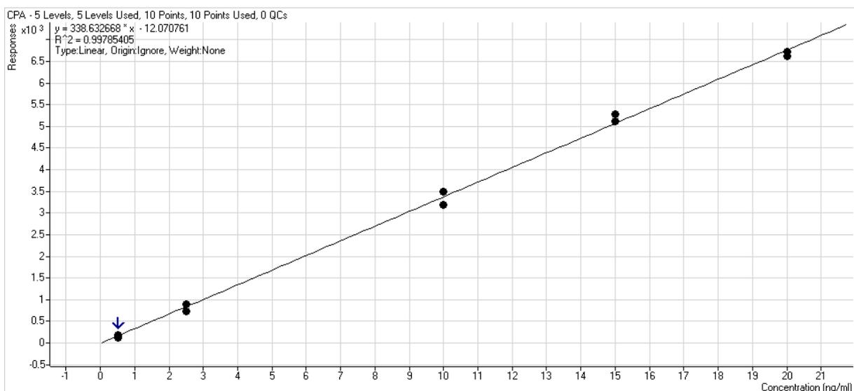
**Slika 52.** Standardna kalibracijska krivulja CPA – linearnost u koncentracijskom rasponu od 0,50 - 20,00 ng/mL
