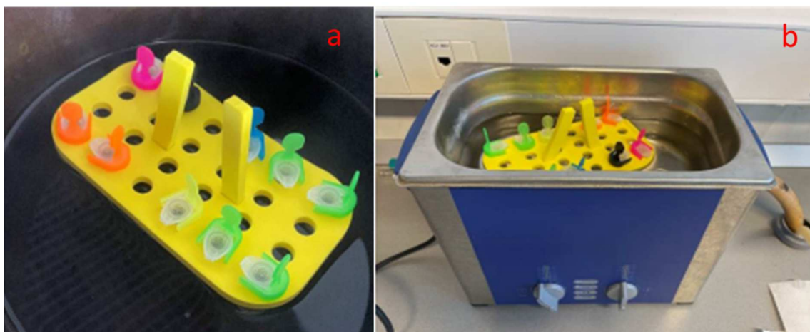
Slika 20. Uzorci u vrućoj vodenoj kupelji (a) i ultrazvučnoj kupelji (b) (vlastita fotografija).
