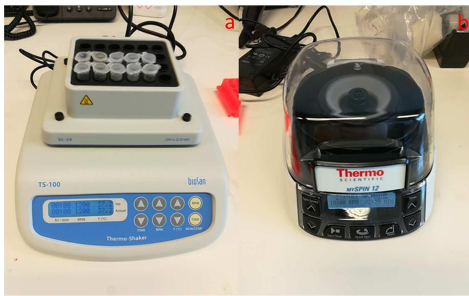
**Slika 32.** Simuliranje dvofaznog *in vitro* modela probave: stavljanje uzorka na probavu u inkubator (a) i centrifugiranje uzorka (b) (vlastita fotografija).
