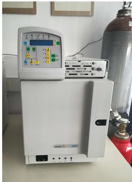
Slika 35. GC-FID uređaj (vlastita fotografija).
