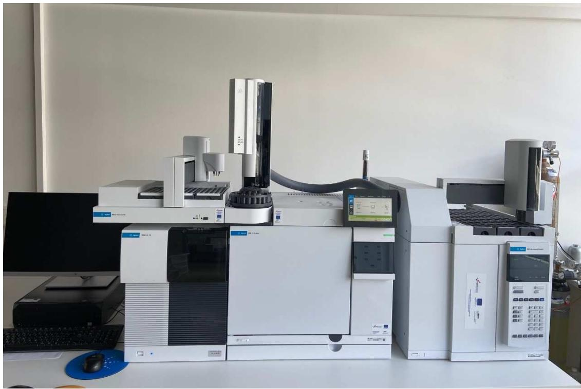
**Slika 27.** GC-MS/MS uređaj (vlastita fotografija).
