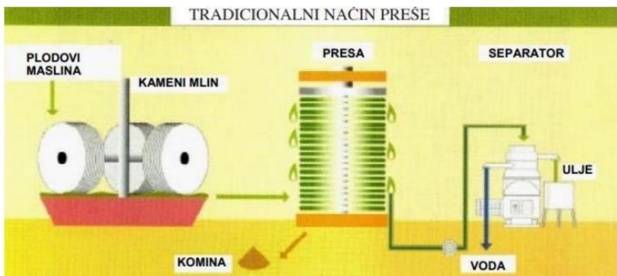
Slika 1. Opća shema proizvodnje maslinovog ulja postupkom prešanja (Gugić, 2006)
