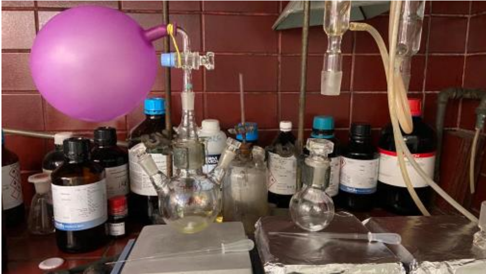
Slika 4. Aparatura za provođenje reakcije dinamičke kinetičke rezolucije i kinetičke rezolucije ( R,S )-1-feniletanola (vlastita fotografija)
