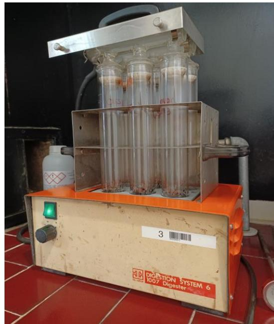
**Slika 6.** Blok za spaljivanje sa kivetama u digestoru
