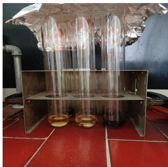
**Slika 7.** Kivete s uzorcima u bloku za spaljivanje nakon procesa spaljivanja
