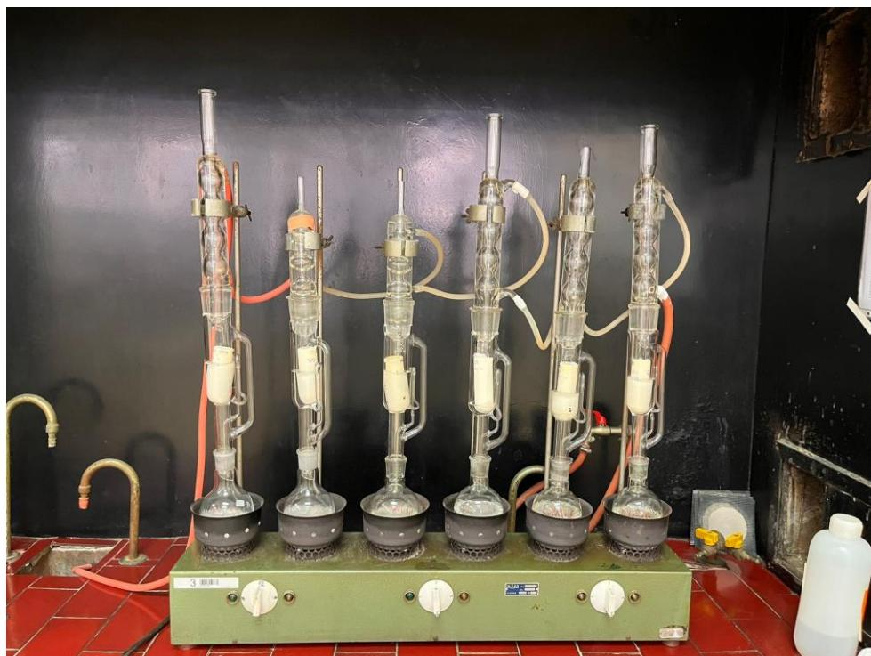
**Slika 9.** Soxhletova aparatura za određivanje udjela masti u uzorcima
