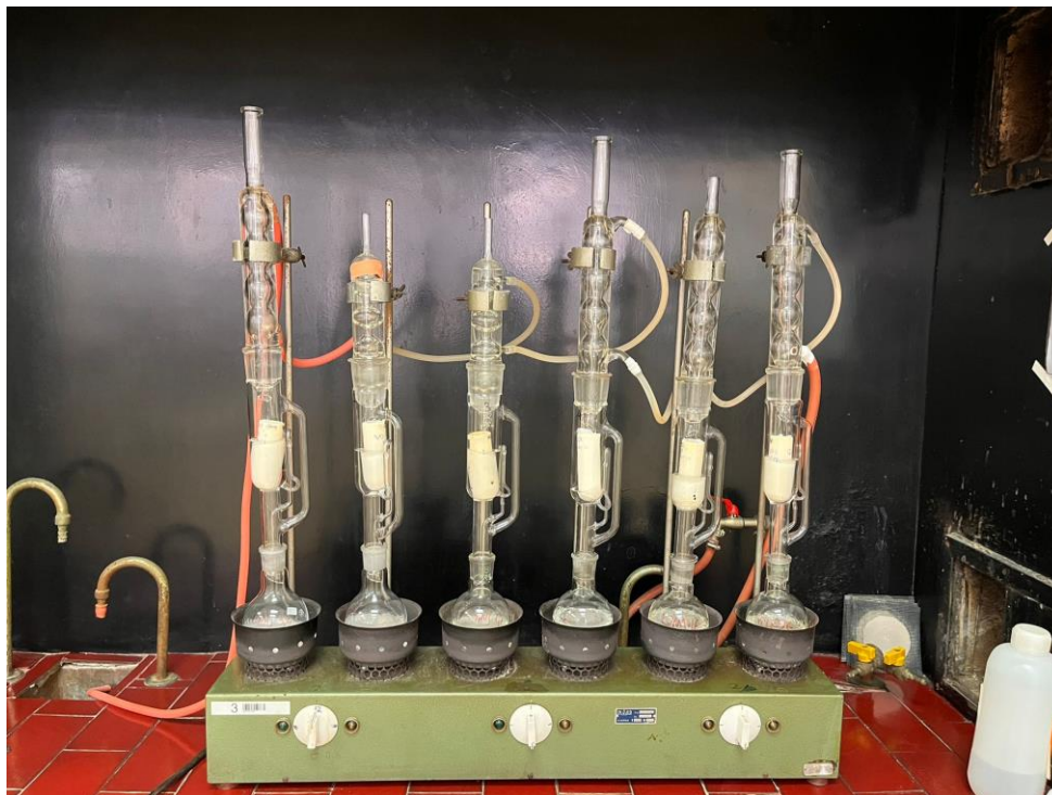
Slika 9. Soxhletova aparatura za određivanje udjela masti u uzorcima (vlastita slika)
