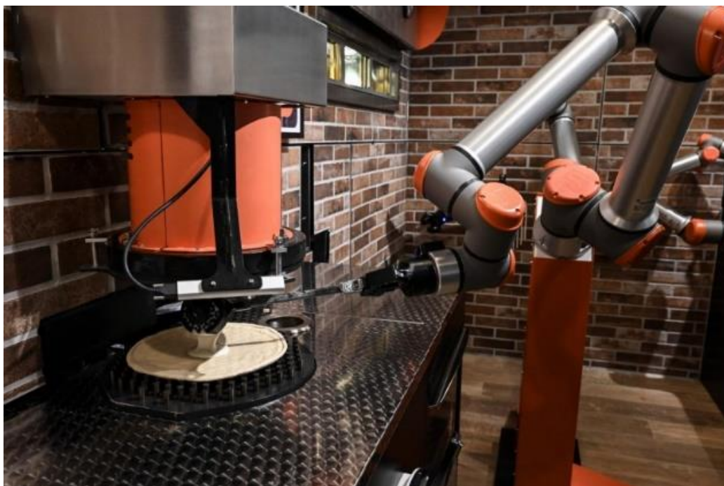
Slika 17. Robot za pripremu i pečenje pizze (Anonymous 11)
