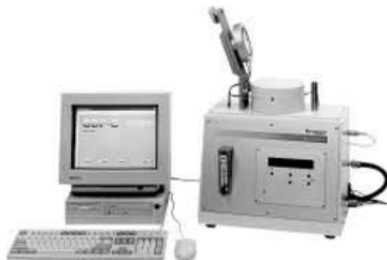
Slika 9. Uređaj za određivanje propusnosti plinova (Anonymous 4, 2022)
