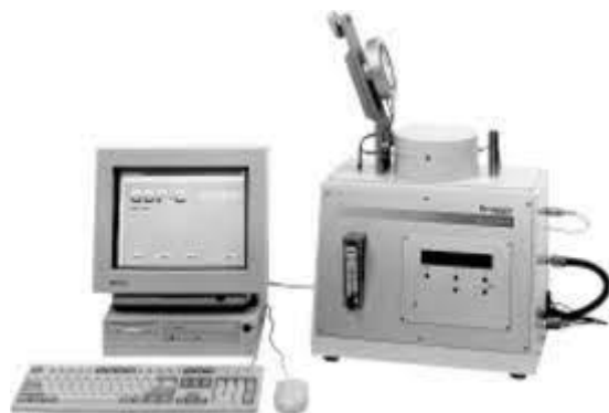
Slika 9. Uređaj za određivanje propusnosti plinova (Anonymous 4, 2022)
