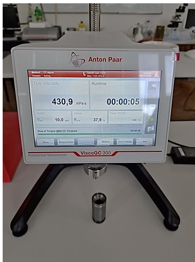
Slika 6. Rotacijski viskozimetar ViscoQC 300
