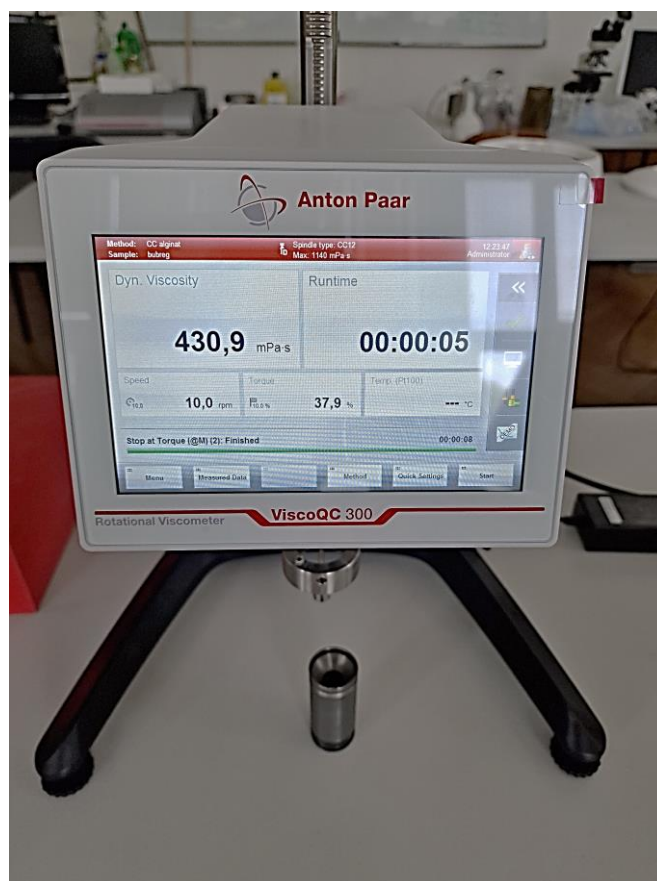
Slika 6. Rotacijski viskozimetar ViscoQC 300
