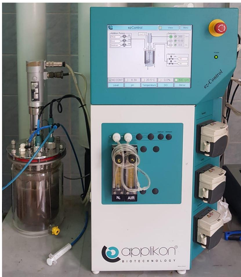
**Slika 11.** Laboratorijski uređaj za mjerjenje biološke aktivnosti aktivnog mulja
