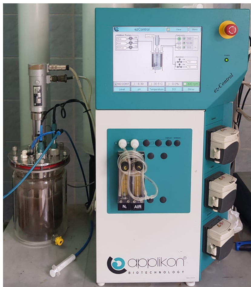
Slika 11. Laboratorijski uređaj za mjerenje biološke aktivnosti aktivnog mulja
