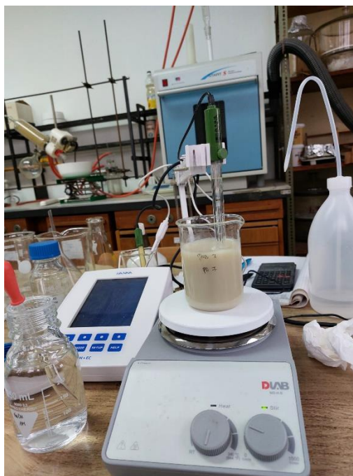
Slika 4. Podešavanje pH vrijednosti na magnetskoj miješalici ( vlastita fotografija )
