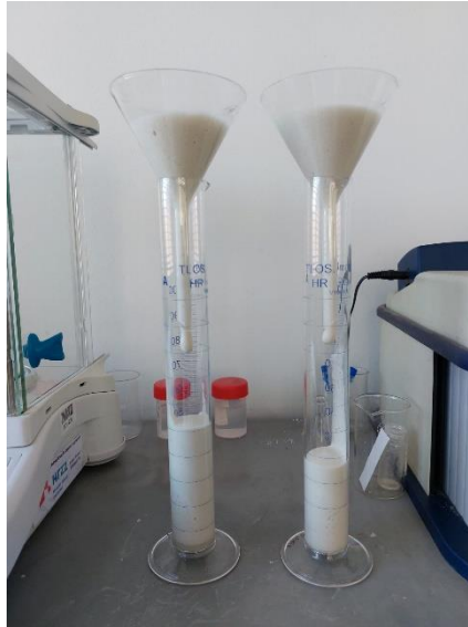
Slika 5. Određivanje stabilnosti pjene metodom prve i zadnje kapi ( vlastita fotografija )
