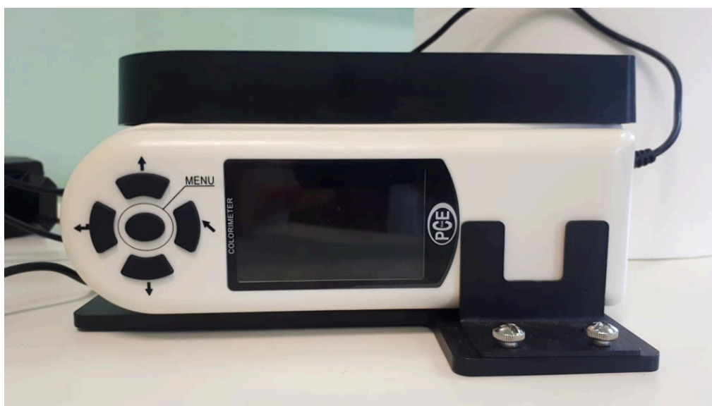
Slika 1. Prikaz kolorimetra PCE-CSM3 (PCE Instruments, Njemačka) za mjerenje parametra boje (vlastita fotografija)
