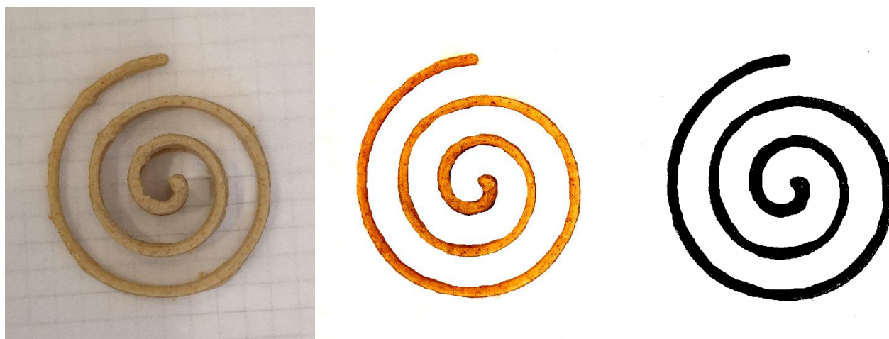
Slika 8. Obrada fotografija u ImageJ programu: a) fotografija uzorka prije obrade b) nakon prilagođavanja kontrasta c) binarna fotografija
