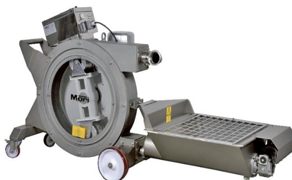
Slika 14. Peristaltička pumpa s usipnim košem za kominu (Pa – vin d.o.o., 2022a)
