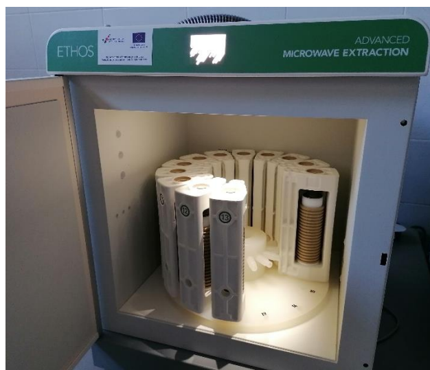
Slika 3. Uređaj za MAE Ethos X, Milestone ( vlastita fotografija )
